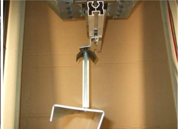
**Bild 13** Zugversuch an Stahlschraube mit Hülse
