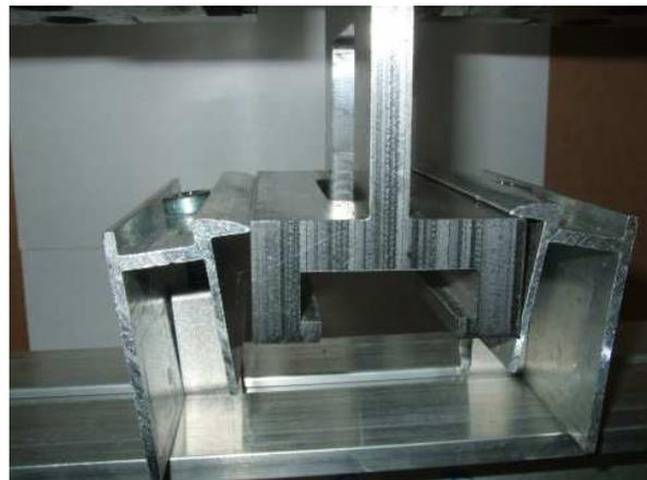
**Bild 8** Versagen von Randklemmen durch Abrutschen
