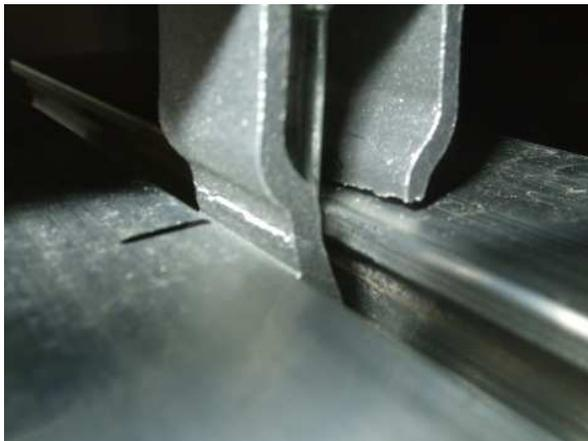
**Bild 7** Versagen der Montagekralle
