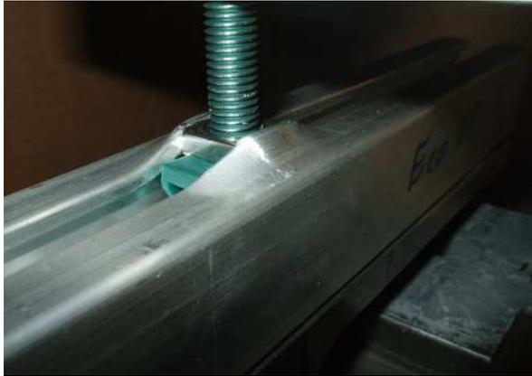
**Bild 5** Versagen des Schraubkanals
