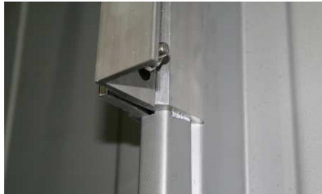
**Bild 17** Falzklemme im Schubversuch
