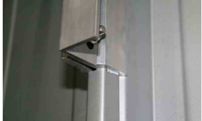
Bild 17 Falzklemme im Schubversuch
