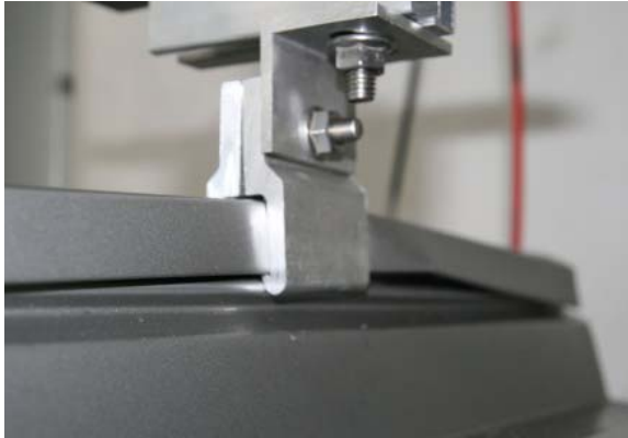
Bild 16 Falzklemme im Zugversuch
