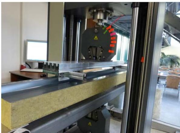
**Bild 2** Laborversuche an einem Sandwichelement
