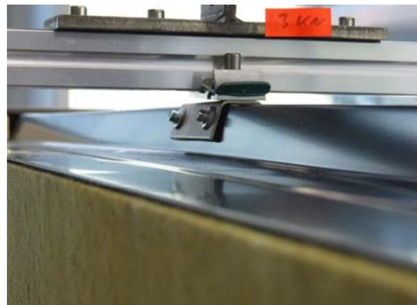
**Bild 3** Deformation unter Zugbeanspruchung
